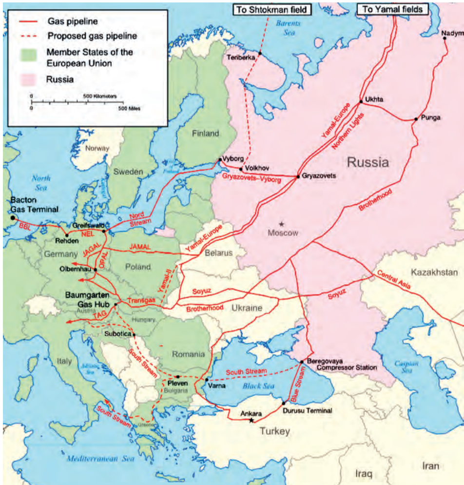
Abb.III.1.12 Verlauf osteuropäischer Gaspipelines
